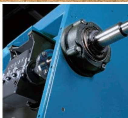
Neu entwickelt: Schmutzresistente Spannhülsenlagerung für hohe Drehzahlen und starke Stoßbelastung
