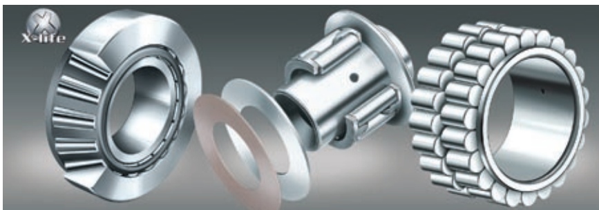
Getriebelager in großer Vielfalt: Kegelrollenlager in X-life-Premiumqualität, z. B. für den Achsantrieb – Planetenradlagerung mit extremer Aufnahmekapazität für Zentrifugalkräfte – zweireihiges Zylinderrollenlager ohne Außenring für Planetengetriebe
