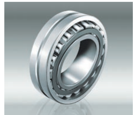
Für schwerste Beanspruchungen: Pendelrollenlager nehmen hohe radiale und beidseitig axiale Kräfte auf
