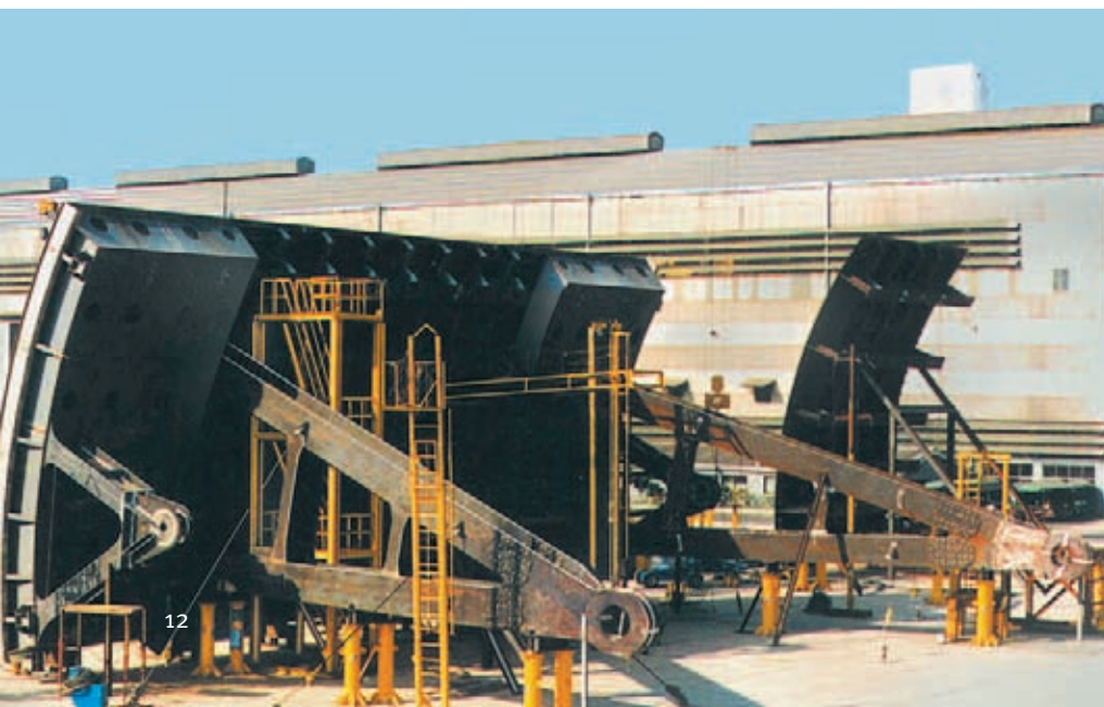
Gigantisch: Die Segmentschütze im Staudamm Saemangum sind 15 Meter hoch und 30 Meter breit
