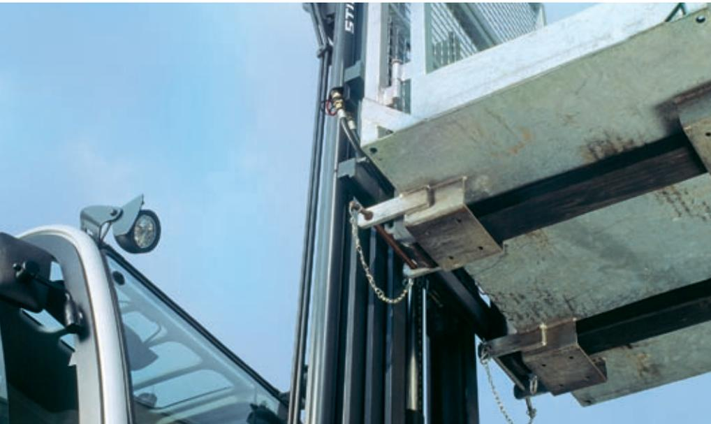
Hubmast- und Kettenumlenkrollen sichern die präzise Bewegung der Hublast
