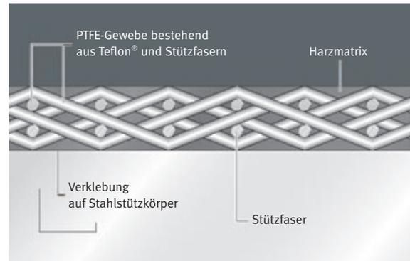
Die Hochleistungs-Gleitbeschichtung ELGOGLIDE® (Prinzipiskizze)
