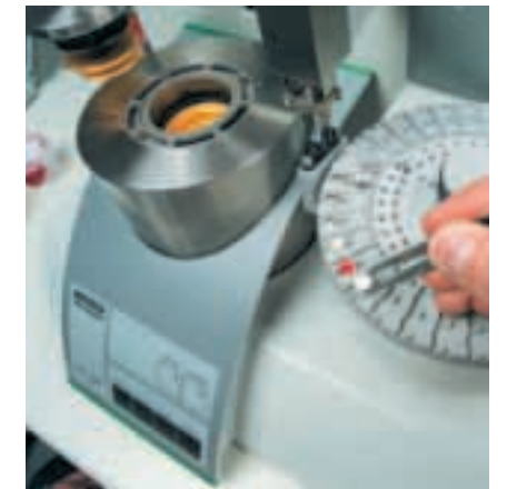
DSC-Analyse: Das Temperaturverhalten von Schmierstoffen, untersucht mit modernsten Methoden
