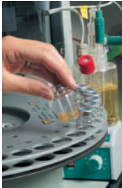
Prüfung im firmeneigenen Labor: Untersuchung von Schmierstoffen auf Wassergehalt
