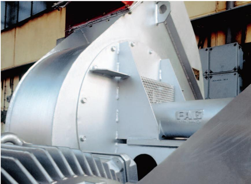
Radialventilator mit Lagereinheit VRE3
