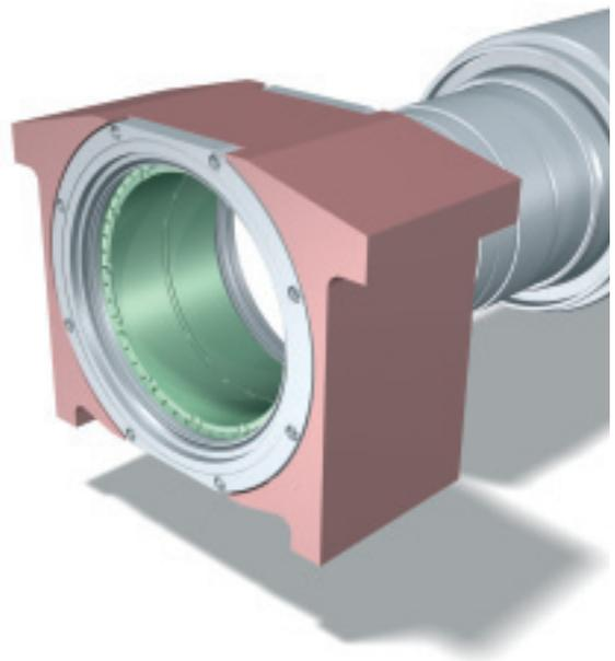
12: Aufschieben des montierten Einbaustücks
