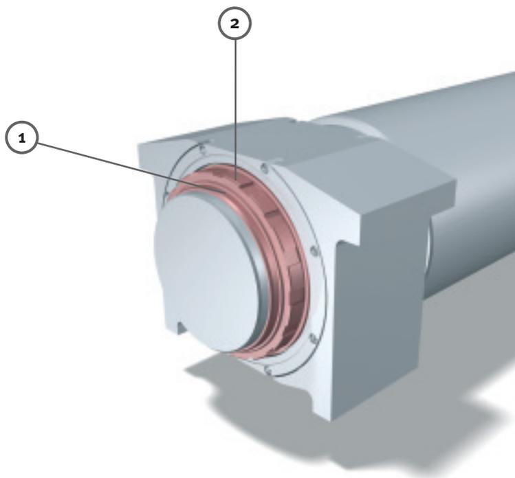
13: Axiale Sicherung mit Wellenmutter
