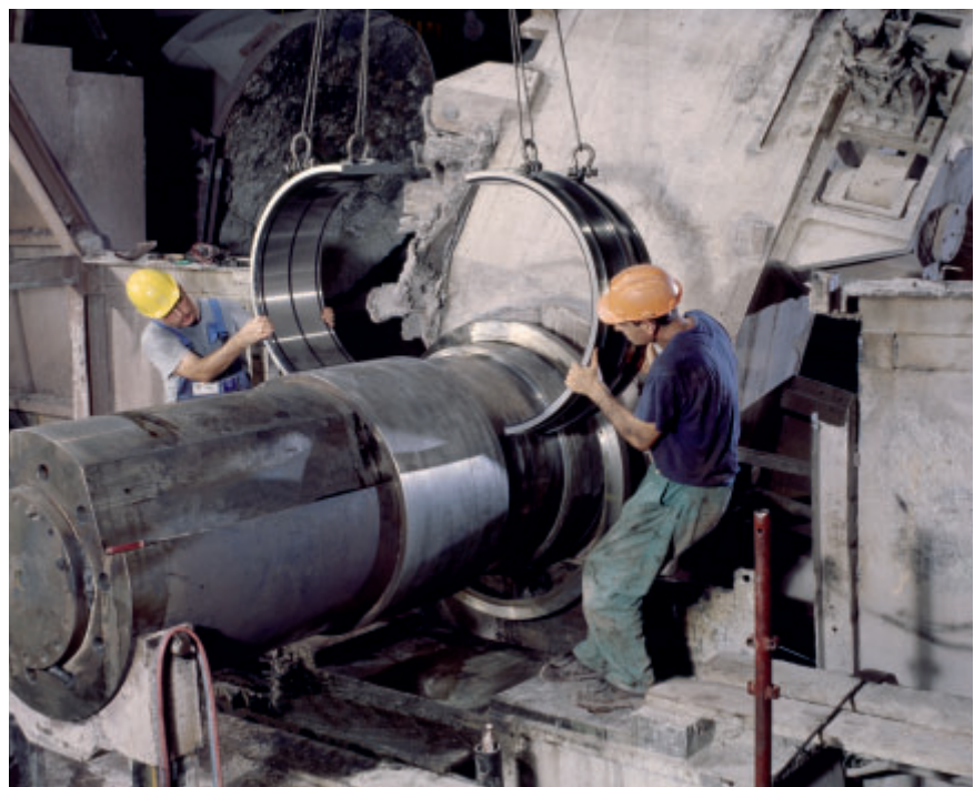
Montage eines großen geteilten Pendelrollenlagers
