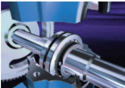
6 Zur Belastung des Lagers Welle absenken
