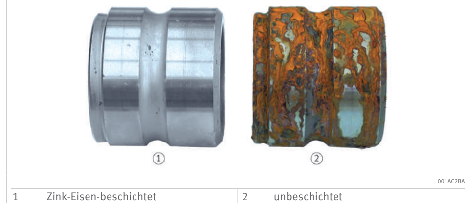
☞ 3 Beschichtetes und unbeschichtetes Teil nach Salzsprühnebelprüfung, Prüfzeit 24 h im Salzsprühnebel
