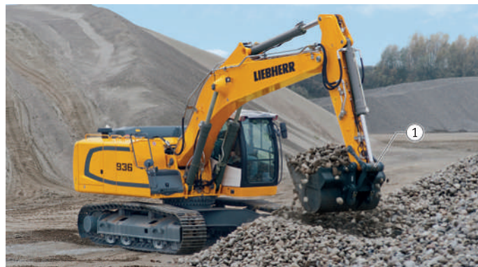
☞ 27 Anwendungsbeispiel mit hoher Verschleißbelastung: Gelenklager im Bagger
